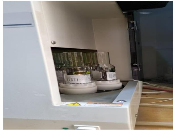
الشكل ( ٦ ) ( ٧ ) جهاز الامتصاص الذري Atomic-Absorption Spectroscopy
